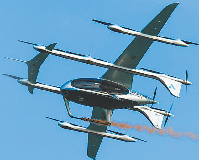
今年2月27日,5座eVTOL(电动垂直起降)航空器盛世龙在深圳蛇口邮轮母港附近海域上空飞行。新华社资料图片
