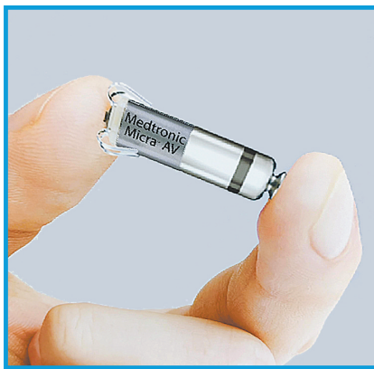
小如胶囊的无导线起搏器
