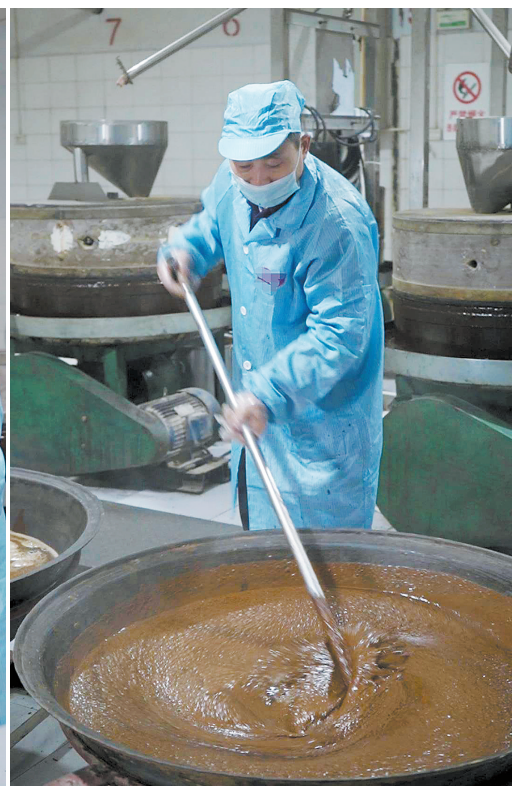
兑浆搅拌，为撇油、取油做准备
