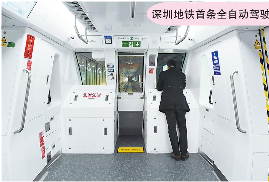
取消驾驶室的全自动列车为乘客增加了新的乘车体验,搭乘地铁过程中,乘客可在首尾车厢直接看到地铁隧道全貌,体验“隧道穿梭”(12月28日摄)。12月28日,深圳地铁20号线开通初期运营。该线起于机场北站,终至会展城站,共设5座地下车站,全长8.43公里,连接深圳宝安国际机场、穗莞深城际铁路以及深圳国际会展中心。作为深圳首条全自动驾驶线路,20号线采用8节编组的全自动驾驶列车,列车最高运行速度为120公里/小时。
