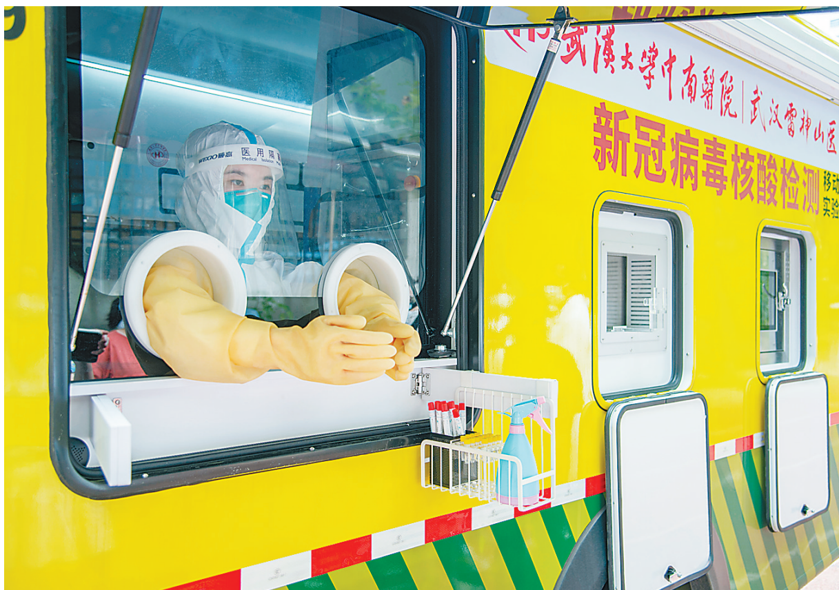
8月5日,来自武汉大学中南医院的移动核酸检测车驶入武昌区东湖路社区,为居民提供核酸检测服务。检测车内搭载核酸咽拭子采样机器人、快速灭活仪和5G检测直报系统等全自动、便携式一体化新冠病毒核酸检测设备,45分钟内就能得出核酸检测结果。 新华社发(伍志尊摄)
