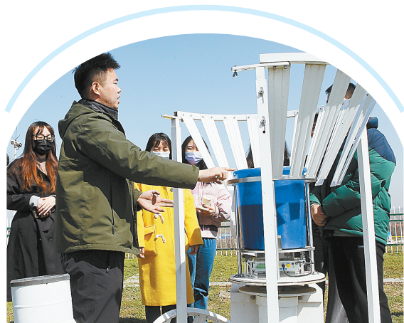
观测员在为来参观的平顶山学院的学生介绍称重式雨量计的作用和工作原理。观测员不仅是气象工作者,还是气象知识的宣传员。
