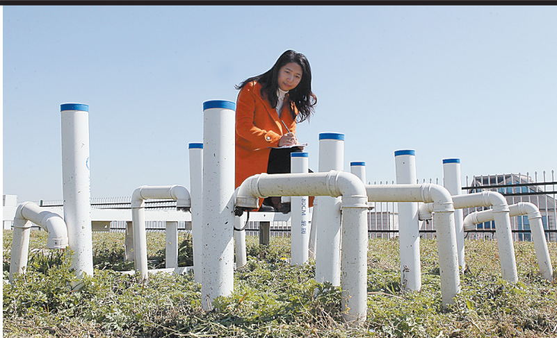
▲插入地下的一根根白色管子是地温传感仪,它提供的数据对农作物种植培育、建筑土方施工具有重要参考作用。
