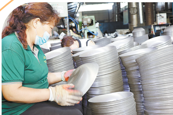
工人检查即将进入下道工序的锅坯
