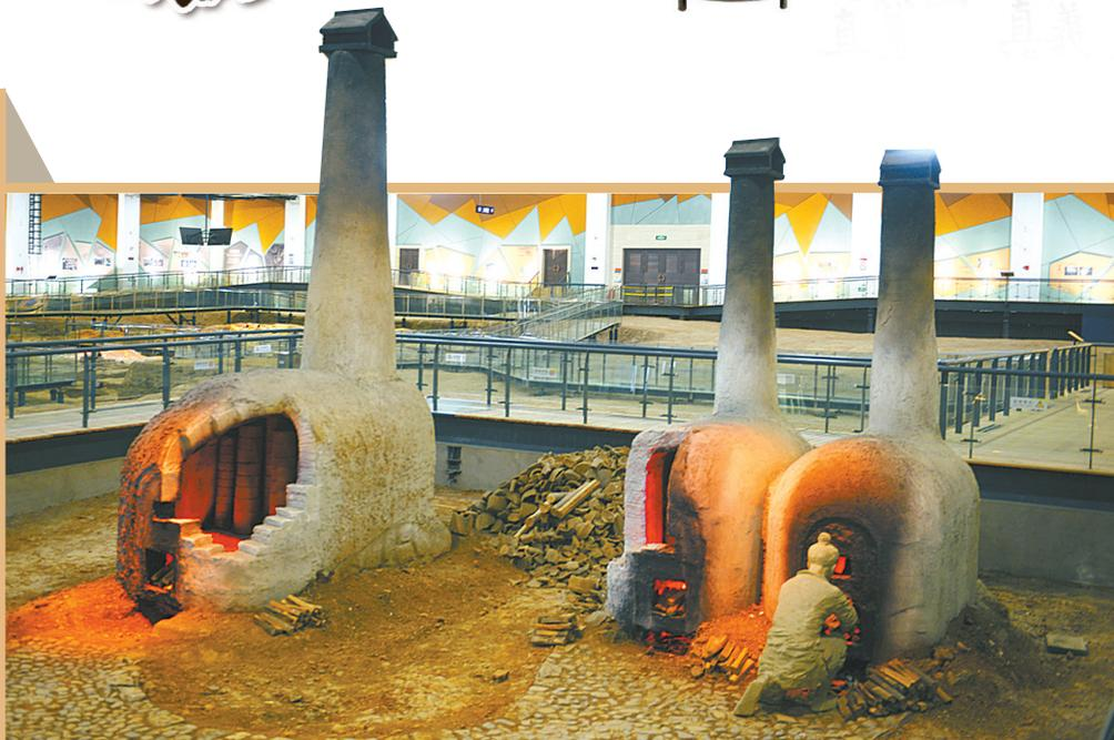
汝瓷烧制模拟窑炉
