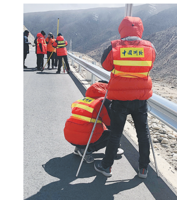
此次珠峰高程测量,通过前期的水准测量(上图、左图)、三角高程测量等高程控制网的方法,把黄海水平面的数值一一传递到拉萨——日喀则——定日县——珠峰脚下,再通过布设的6个交会点,把高程数值传递到珠峰峰顶,通过在峰顶竖立的红色珠峰高程采集数据。(澎湃)
