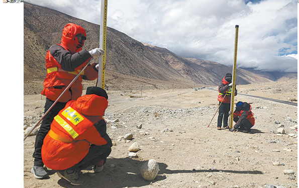
此次珠峰高程测量,通过前期的水准测量(上图、左图)、三角高程测量等高程控制网的方法,把黄海水平面的数值一一传递到拉萨——日喀则——定日县——珠峰脚下,再通过布设的6个交会点,把高程数值传递到珠峰峰顶,通过在峰顶竖立的红色珠峰高程采集数据。(澎湃)
