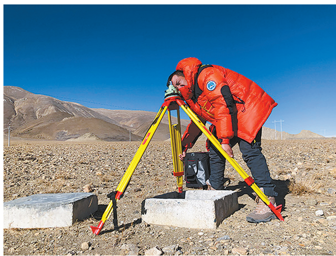
下图为GNSS测量的测量队员正寻找固定标准高度,准备安装链接卫星的设备。(澎湃)
