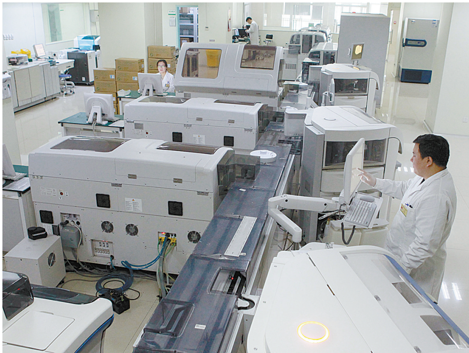
昨天，在市一院医学检验科，工作人员使用西门子生化免疫全自动流水线为患者进行生化指标检验。
