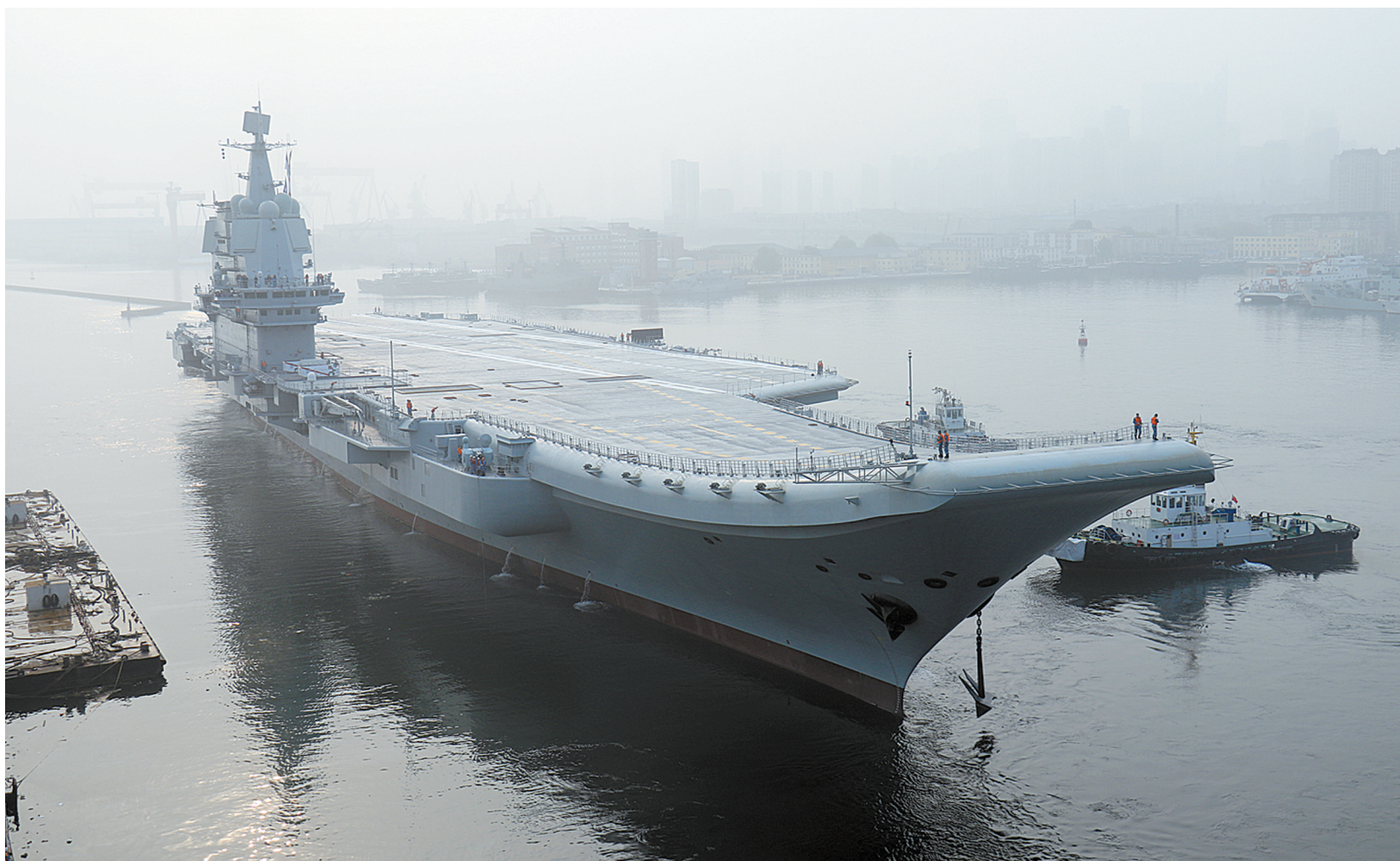
5月13日,我国第二艘航母从大连造船厂码头启航,赴相关海域执行海上试验任务,主要检测验证动力系统 etc 的可靠性和稳定性。国产航母离港后,其自主研发的动力系统和推进系统将首次接受海洋环境的真正考验。据了解,自去年4月26日下水以来,第二艘航母建造工作按照计划稳步推进,完成了系统设备调试、舾装施工和相关系泊试验,具备了出海试验的技术条件。新华社发(李刚 摄)
