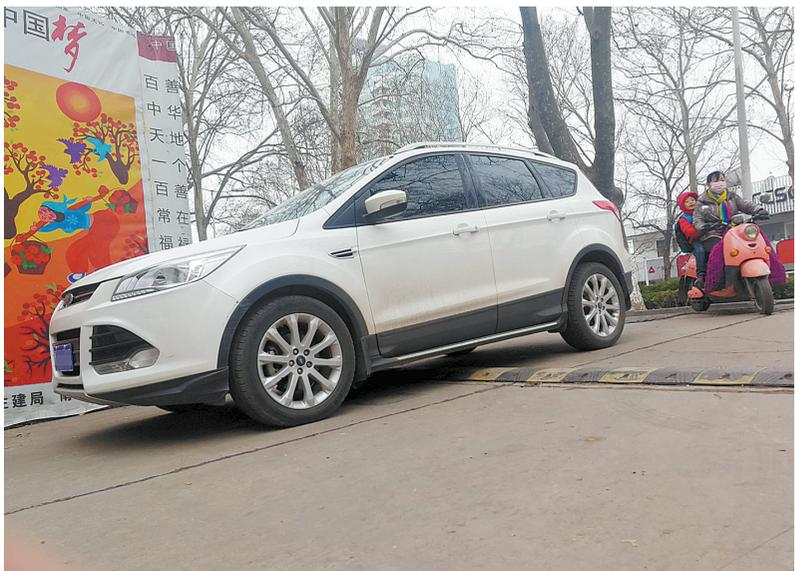
**坡道长时间停车:**汽车在坡道上停放,通过手刹拉线将车辆固定住,所以,手刹拉线要一直承担着整车在坡面上的分力。长时间在坡道上停车会使手刹拉线产生“疲劳”,进而影响制动效果,甚至有可能使手刹丧失制动性能,酿成溜车事故。
