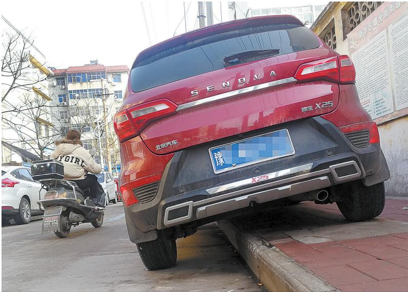
**停车一侧上台阶:**在这种状况下,车身向一侧倾斜,防倾杆长期受力,经常这样停车很容易产生金属疲劳会使轮毂部位发生变形。
