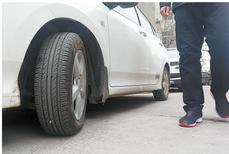
**方向盘打死停放:**将方向盘打死驻车和原地打方向,不仅会加速轮胎磨损,同时也会造成转向系统老化变形以及悬挂系统受损。
