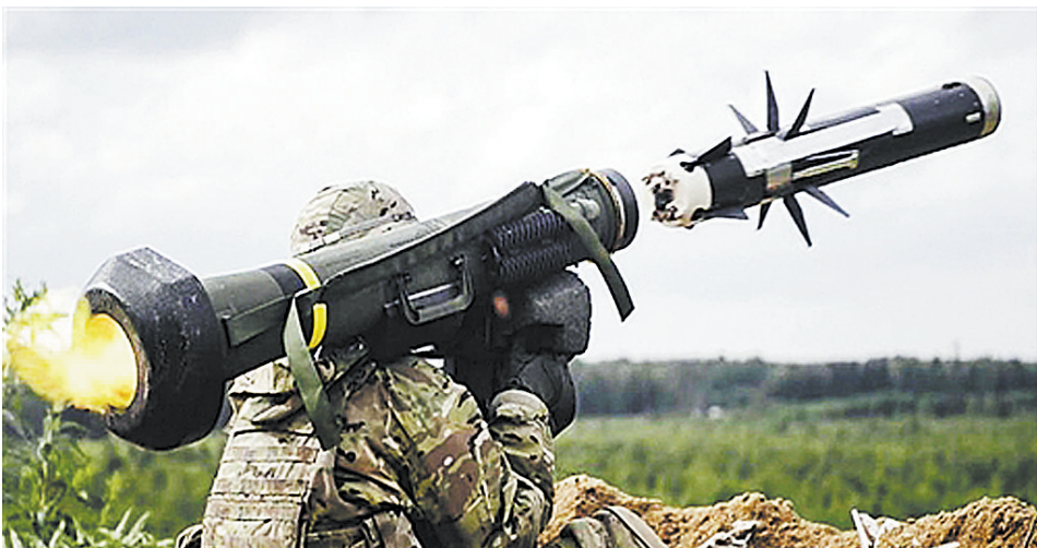
1996年装备美军的“轻标枪”导弹是一种全自动导引、图像制导的反坦克导弹,具有昼夜作战和发射后不管能力,射程2000米,改进型导弹的射程延伸至4500米。(资料图)
