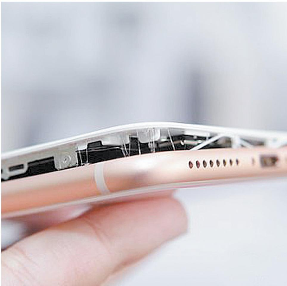
度的现象导致肿胀。对于尚未充电即发生肿胀的电池,则可能是电池的设计存在问题导致的,电池在未使用时内部便发生了化学反应,造成胀气现象。”王敬忠表示,事故具体原因还要实际检查故障电池的情况才能下定论,而从媒体报道的事例来看,这些用户的iPhone 8手机多是在充电时发生故障,这或许是因为安全线路出了问题。
