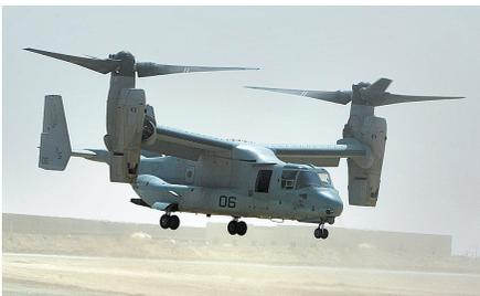
MV-22倾转旋翼机绰号“鱼鹰”，是一种将固定翼飞机和直升机特点融为一体的新型飞行器，有人形象地称其为“空中混血儿”。
