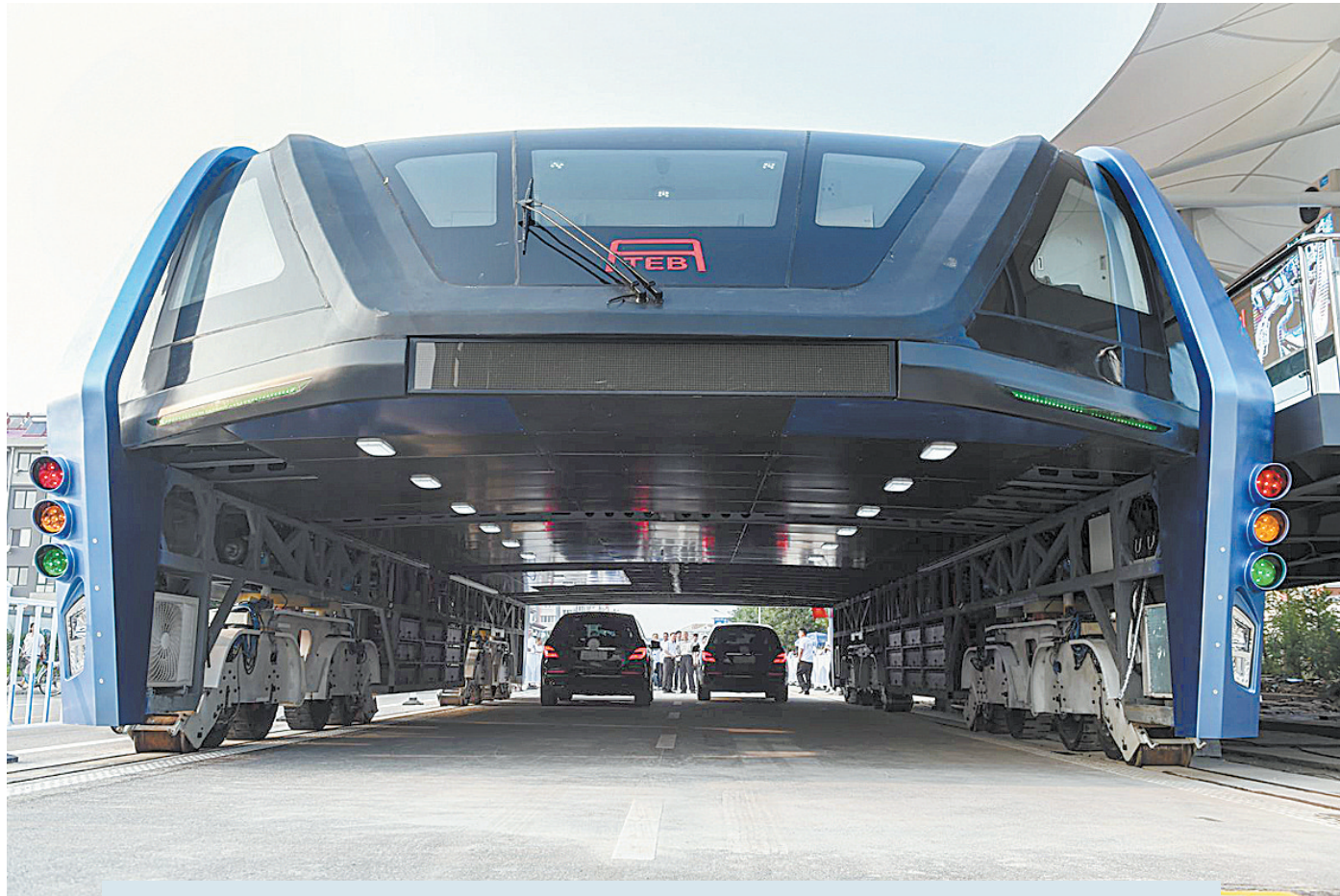
巴铁是一种立体快巴。这种立体快巴是宽体高架电车,介于大巴与有轨电车之间,行驶于轻轨铁路而成为巴铁,即快巴铁路,上层运送人群,下层留有通道,能通行车辆,车身由多车厢连接而成,以便转弯。该运输方案发明人是宋有洲,开发商是巴铁公司。图为2016年8月2日,巴铁1号试验车在河北秦皇岛北戴河区启动综合试验。 新华社
