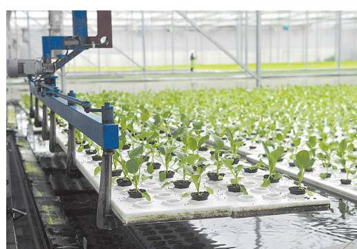
6月13日,浙江省台州市黄岩区绿沃川农场中的自动化系统将蔬菜秧苗置入水培池。占地近300亩的绿沃川农场,立足于高科技农业种植,集合了自动化、智能化、工厂化、无土栽培和立体化种植等技术。
