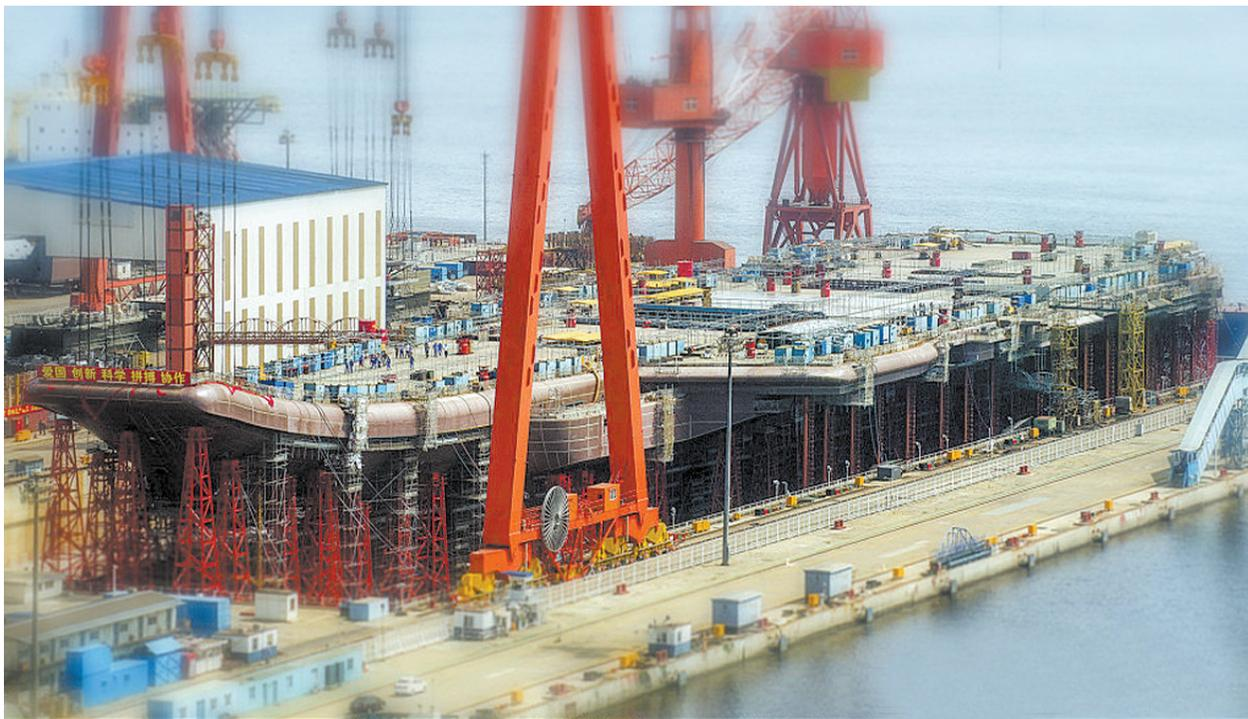
近日,正在建造的国产航空母舰正在拆除脚手架,按照航母的建造顺序,接下来将进行表面喷漆的工序,这意味着该舰距离下水又进了一步。
