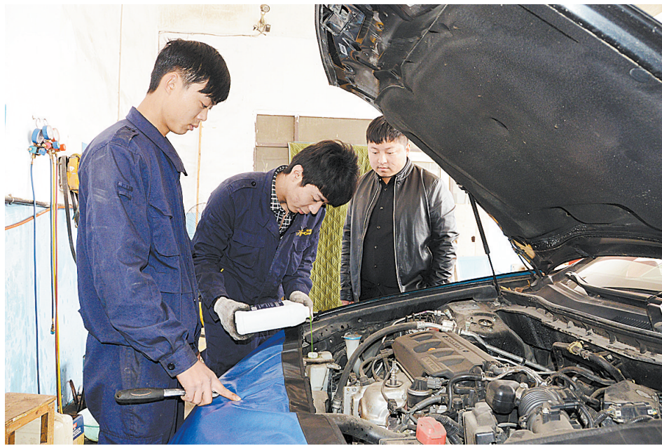
信德汽修的工作人员正在为微车友添加防冻液
