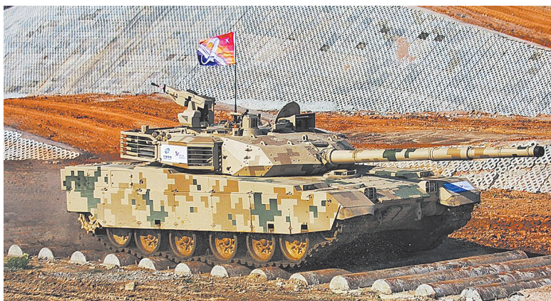
VT-4型主战坦克拥有目前现役的坦克中口径最大的坦克炮,火炮系统性能优越,是由中国兵器工业集团研制的外贸型坦克。
