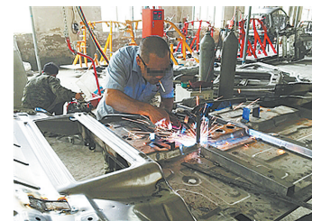
▲6月3日,山东武城县一家代步车生产厂家的车间里,一工人在用锤子敲打“老年代步车”车壳,一工人在焊接车壳。
