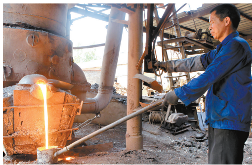
图一：工人从炼铁炉中取出泛着红光的铁水。
