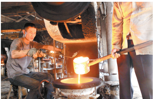
图二：蒸腾的铁水倒入压锅机的模具中。
