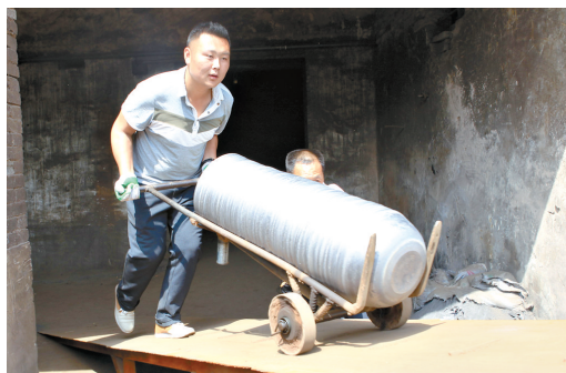
图四：基本成型的铁锅被小车转运至下道工序。
