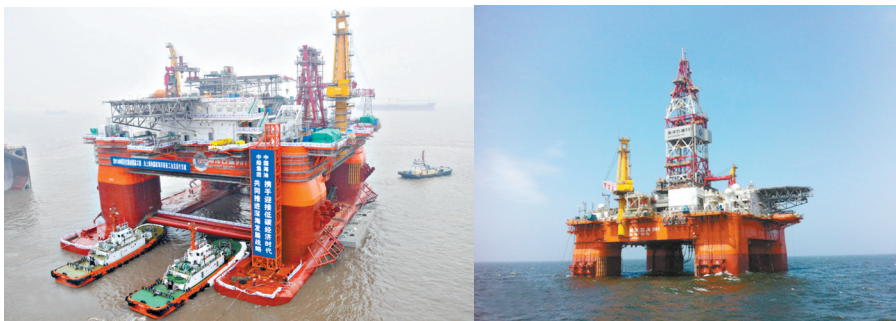
海洋石油981深水半潜式钻井平台(上图)，简称“海洋石油981”，于2008年4月28日开工建设，是中国首座自主设计、建造的第六代深水半潜式钻井平台，由中国海洋石油总公司全额投资建设，是世界上首次按照南海恶劣海况设计的，能抵御200年一遇的台风；选用DP3动力定位系统，1500米水深内锚泊定位，入级CCS(中国船级社)和ABS(美国船级社)双船级。（百度）
