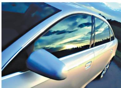
**安全玻璃:**安全玻璃有两种,分别是钢化玻璃与夹层玻璃。钢化玻璃是在玻璃处于炽热状态之下使之迅速冷却而产生预应力的强度较高的玻璃,钢化玻璃破碎时分裂成许多无锐边的小块,不易伤人。夹层玻
