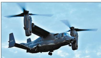
美国海军陆战队的V-22“鱼鹰”运输机是目前世界上唯一投入服役的倾转旋翼机,平飞时速达570公里,起飞重量达27吨。
