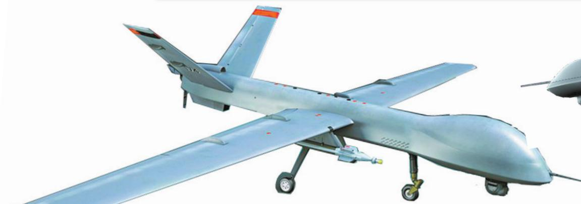
▲“翼龙”无人机于2005年5月开始研制,2007年10月完成首飞,2008年10月完成性能/任务载荷飞行试验,近日完成2015年新年产次编队试飞。它是一架中高空多用途无人机,具备全自主飞行能力,可装载光学/红外相机、光电侦察设备等多种任务载荷和小型空地打击武器,执行监视、侦察等任务。它的机身长超过9米、翼展14米、最高飞行速度240公里/小时、升限海拔5300米、续航时间20小时、最大航程4000公里、任务载荷重量310千克(含燃油)、最大起飞重量1150千克。
