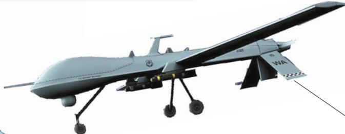
▲“捕食者”无人机是美国空军描述为“中海拔、长时程”(MALE)无人机系统。它可以扮演侦察角色,可发射两枚AGM-114地狱火导弹。它是一种遥控飞行器,机长8.27米,翼展14.87米,最大活动半径3700公里,最大飞行时速240公里,在目标上空留空时间24小时,它的最大续航时间60小时、空重512千克、最大起飞重量1020千克。该机装有光电/红外侦察设备、GPS导航设备和具有全天候侦察能力的合成孔径雷达。
