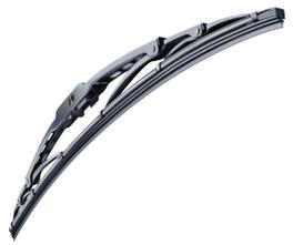
不同的保养要诀。雨天过后应尽快冲刷爱车,因为雨水中的酸性成分容易使胶条老化;冬季清洁玻璃结冰和积雪时,切不可用雨刮器硬刷,这会使雨刮片损坏;经常改变胶条接触面的倾斜形态,防止泛起变形;当雨刮片贴合不严密时,应尽快去专业维修店调换,防止形成安全隐患。
