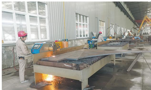
工人对一块金属复合钢板材料进行切割、抛光处理
