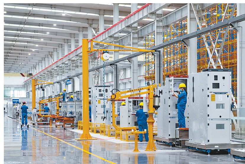
工人在舞钢高低压电气专业组装开关柜(资料图片) 本报记者 王尧 摄
