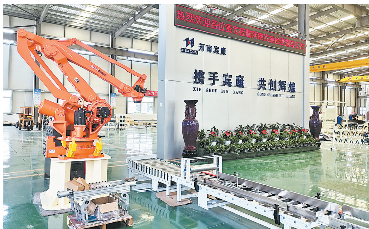
河南安康智能装备有限公司生产的智能高速码坯机 石少华摄
