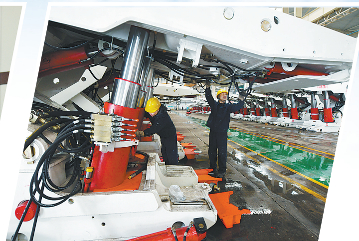
河南矿机有限公司在生产液压支架
