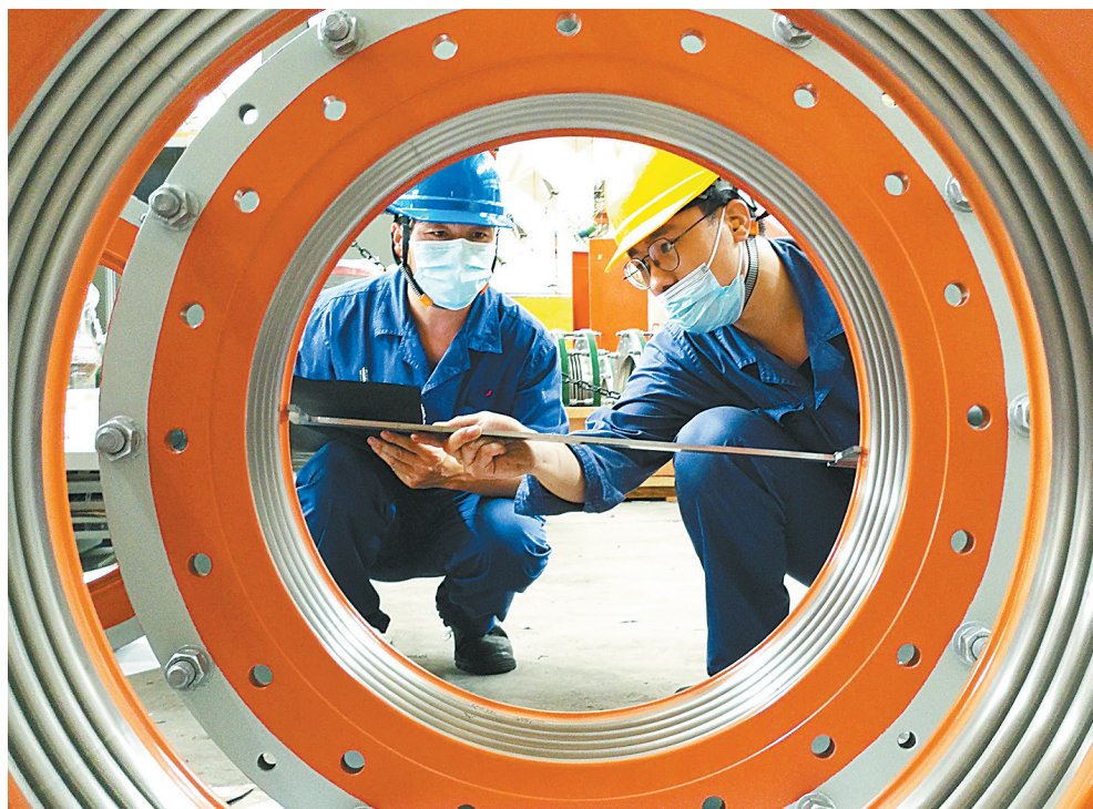
7月4日,河南平高电力设备有限公司的职工在对波纹管进行质检。该公司是平高集团有限
