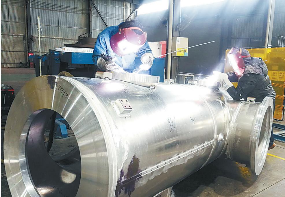
2月9日，平顶山市华匠电器机械制造有限公司员工在焊接高压开关壳体。
