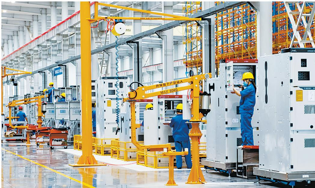
郑县高低压电气专业园项目是市重点建设项目，总投资10.7亿元，主要生产高压智能断路器、变压器等输配电设备。图为园区的天晟电气股份有限公司工人在车间组装开关柜。
