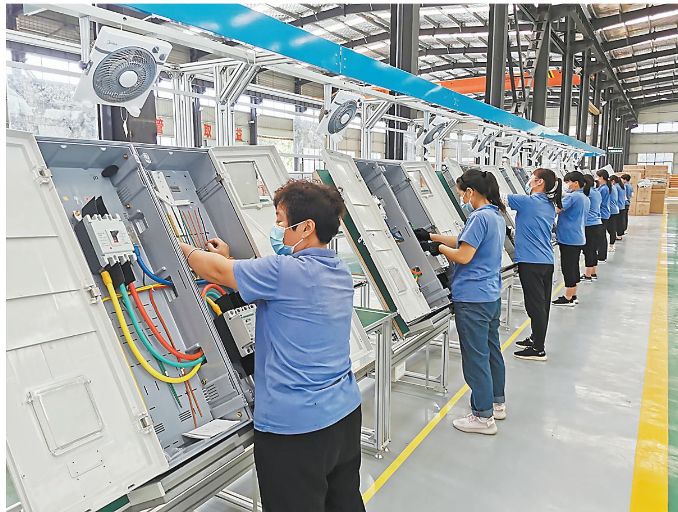
8月24日下午,记者在位于鲁山县产业集聚区的远中电气有限公司生产车间看到,工人正在组装智能化配电箱。该公司引进智能化配电箱生产线4条,可年产各类高低压配电设备5万台,产品销往省内及山东、湖南、湖北等十几个省份,广泛应用于电力、交通、水利等多个行业。 本报记者 常洪涛 摄
