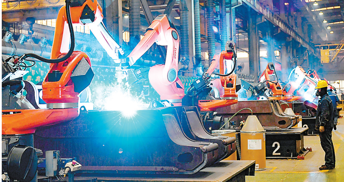
8月23日,智能机器人在平顶山平煤机械装备有限公司车间内焊接新型电液控制液架零件。该公司根据国家能源集团石圪
