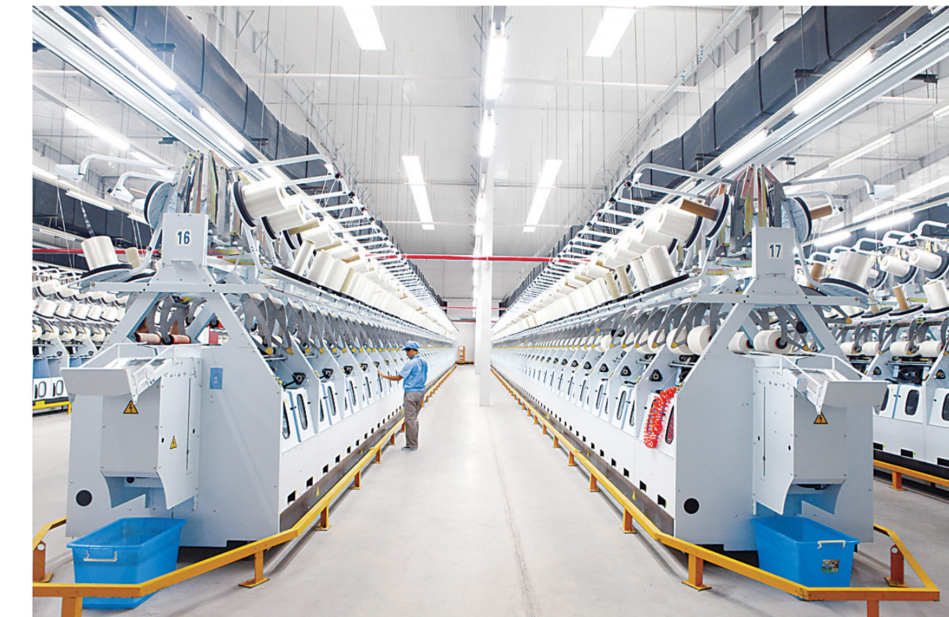
8月17日,在帘子布发展公司捻织车间,工人在检查直捻机运行情况。
