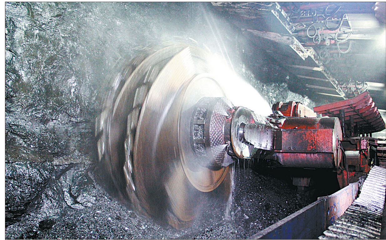
河南省首个6.5米大采高智能化综采工作面
