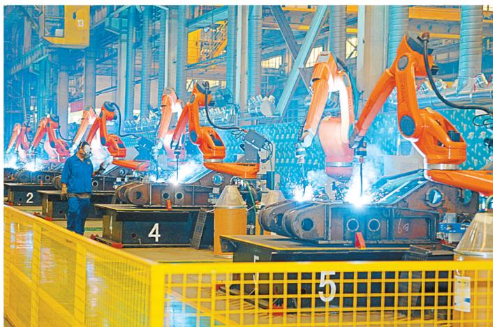
智能机器人在位于郟县产业集聚区的平煤机械煤机装备有限公司车间内焊接液压支架部件(资料图片) 本报记者 王尧 摄
