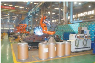
CLOOSE QRH 390-E7轴式焊接机器人
