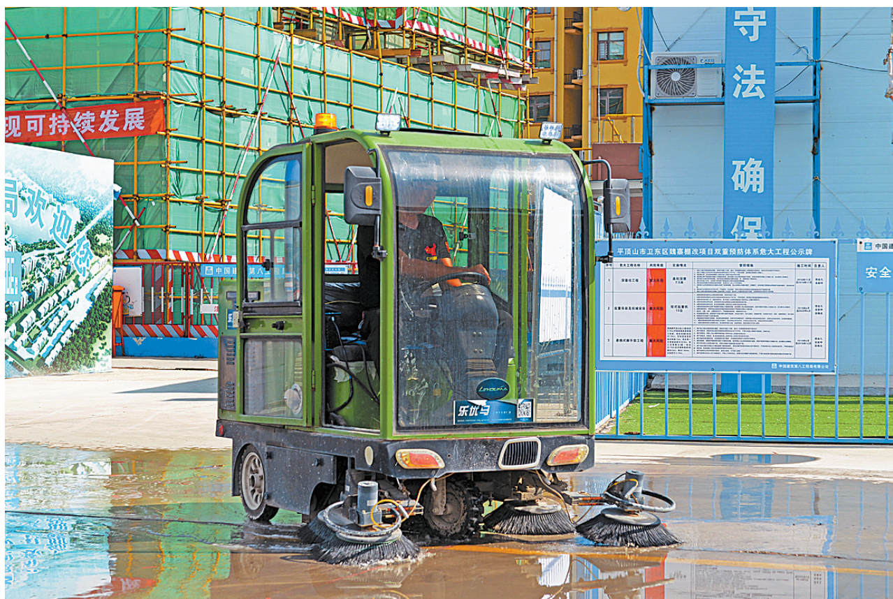
先冲再扫防扬尘
