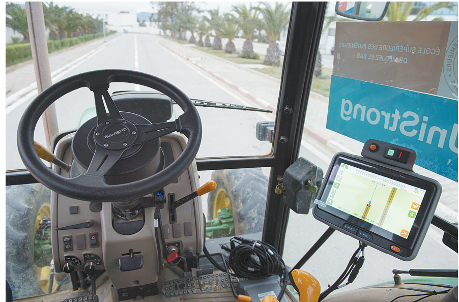
4月1日，在突尼斯首都突尼斯市，一辆安装了北斗卫星导航系统自动驾驶设备的农用拖拉机在第二届中阿北斗合作论坛期间进行无人驾驶展示。 新华社记者 孟涛 摄
