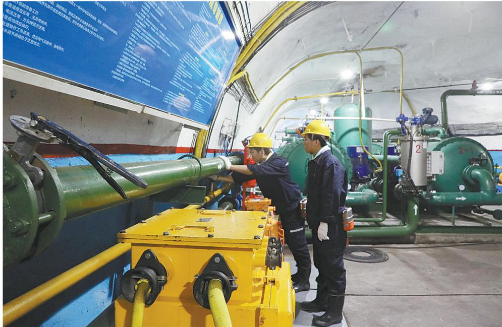
十一矿建成集团首家矿井水井下净化处理硐室，目前已顺利投入运行。该项目采用预处理+陶瓷膜处理工艺，对矿井涌水直接在井下进行净化处理，净化后的矿井水可直接投入生产应用。自6月份投运以来，日产净水2200立方米，预计年可节约水电费用300余万元。
