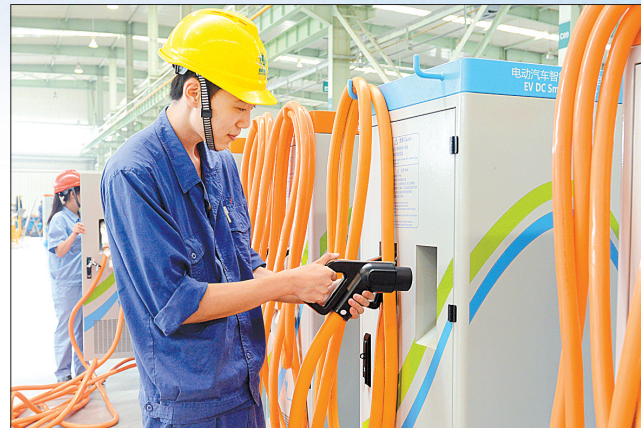
技术人员在平高电气生产车间检测电动汽车智能充电桩 本报记者 王尧 摄
