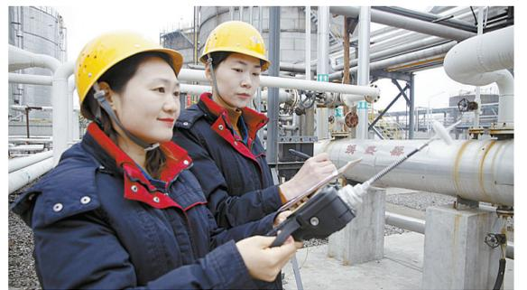
3月18日尼龙化工公司职工正在用手持式检测仪对化学品罐区的VOC进行监测。为加强环境治理,该公司专门成立了监测分析
