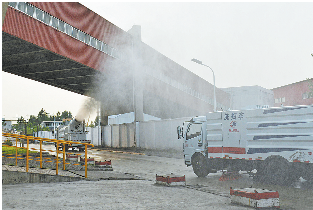
7月4日下午,平顶山姚孟发电有限公司工作人员驾驶多功能清洁车在煤场周边喷雾抑尘。为切实做好大气污染防治工作,该公司除在煤场周围安装防尘网、煤堆喷淋设备等措施外,还每天组织多功能清洁车在周边清扫、喷雾,多种措施并行,防治扬尘。 本报记者 牛智广 摄
