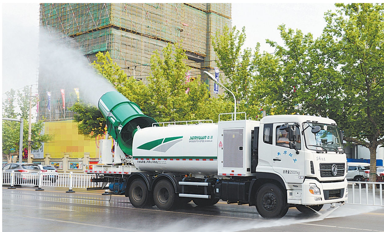
6月14日,新华区环卫局工作人员驾驶多功能抑尘车在建设路中段一在建项目工地附近开展扬尘治理作业。
