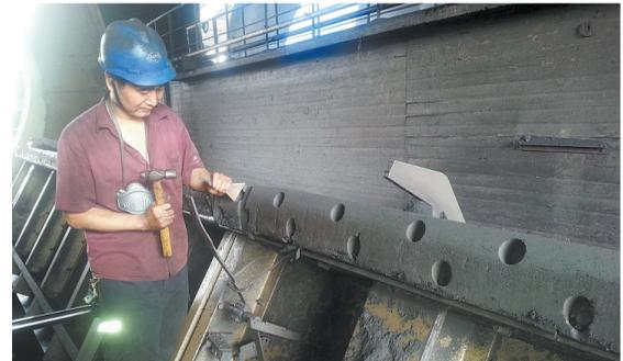
针对翻车机压车信号板断裂的问题,田庄选煤厂储运车间原煤机修班班长韩国保主动攻关,在压车信号板处刻槽进行加固,解决了这一问题。图为5月17日,韩国保正在刻槽。 张站峰 摄
