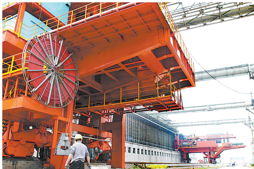
平煤神马集团引进德国最先进的顶装煤焦炉设备 本报记者 李志勇 摄
