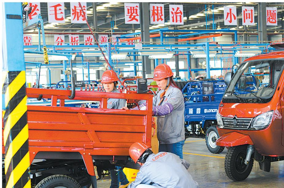
12月7日,工人在位于叶县产业集聚区内的河南隆鑫机车公司生产线上为针对海外市场研发的三轮摩托车安装车棚。
